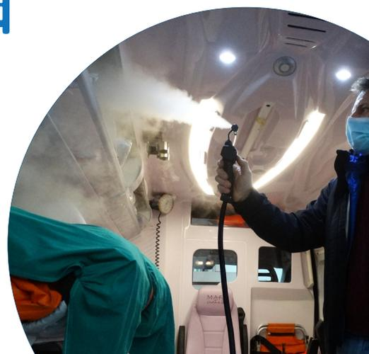
**La macchina è dotata di due serbatoi:** un serbatoio per l'acqua (atto alla ricarica della caldaia a vapore), e uno per l'inserimento del prodotto disinfettante. Magic Vapor Sani lavora con il vapore in armonia al **liquido igienizzante VOC-free** (cod. RIP1519).
